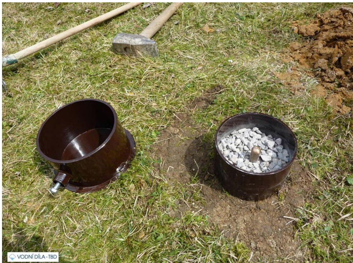
Obr.11 - detail kontrolních měřičských bodů TBD – zarážených značek
